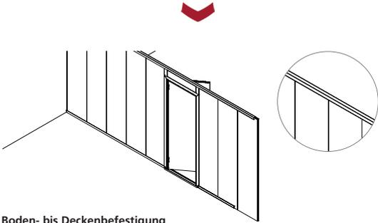
Boden- bis Deckenbefestigung mittels U-Profil oben und unten
