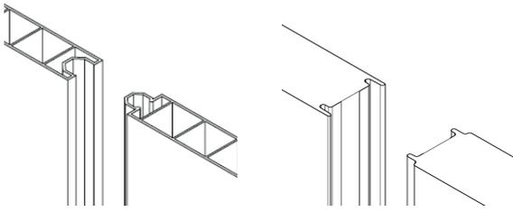
Nut- und Feder-System für eine schnelle und einfache Montage
